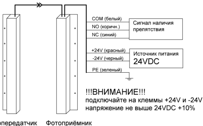
Рисунок 1 - Электрическое подключение фотоэлектрического барьера
