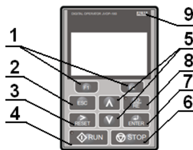
Рисунок 5.2 - Внешний вид цифровой панели управления
